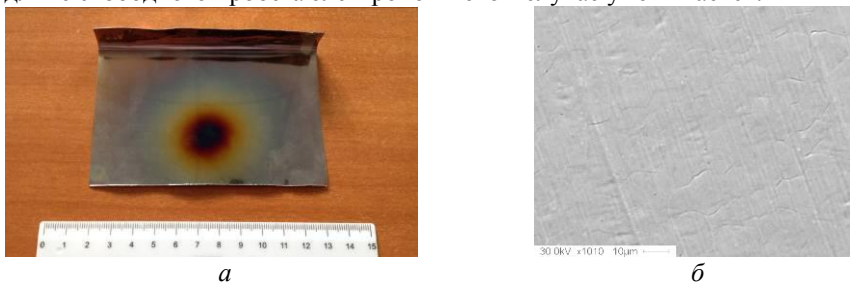
Рисунок 9 – Фотография отпечатка (а) и его увеличенный вид (б), оставленного на пластине из нержавеющей стали, установленной на расстоянии 100 мм от нового катодного узла и находящейся под потенциалом полого анода, после прохождения N=10^5 имп. при I_p=60 А, t=40 мкс, f=20 с -1
